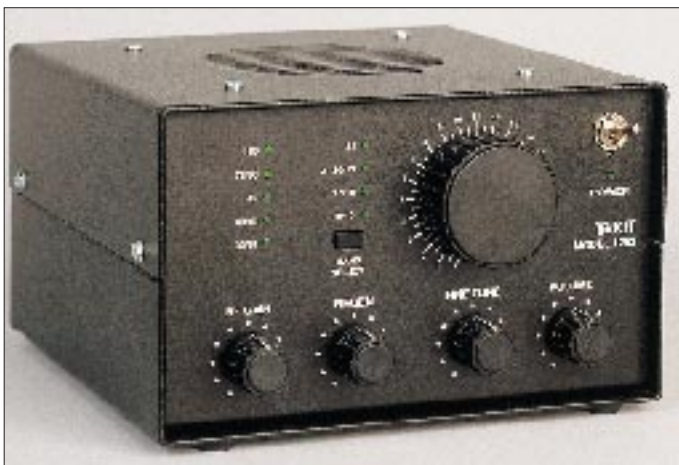
Frontansicht des Ten-Tec 1253. Um bestmögliche Empfangsergebnisse zu erzielen, ist das optimale Zusammenspiel von Frequenzfeinabstimmung (Fine Tune), Rückkopplung (Regen.) und HF-Verstärkung (RF Gain) wichtig.
