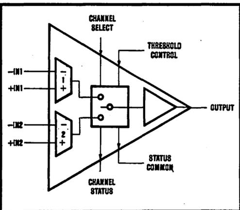
FIGURE 1. Block Diagram of the OPA201 SWOP AMP.
