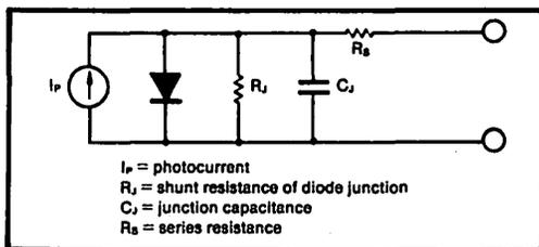
FIGURE 1. Photodiode Equivalent Circuit.
