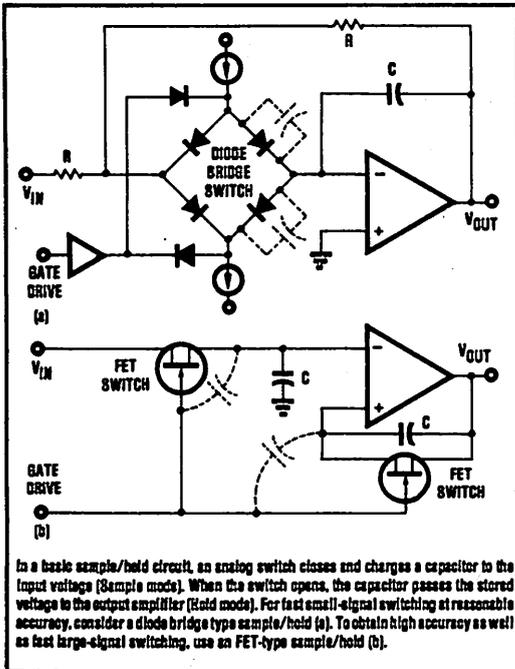
**FIGURE 1. Diode-Bridge and Junction-FET Sample/ Hold Circuits.**
