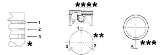
\* Fit rings «2» and «3» with the word «TOP» facing upwards.
