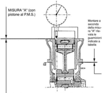
N.B. la misura "A" deve assere rilevata senza nessuna guarnizione montata tra carter e cilindro
