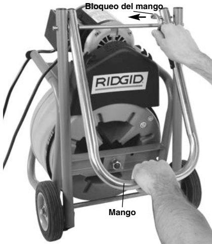
Figura 9 – Operación del mango
