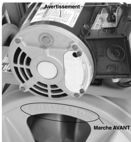
Figure 8 – Rotation du tambour en position FOR (marche avant)
