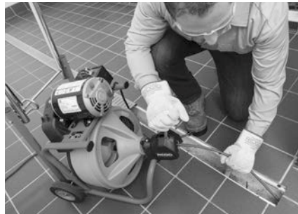
Figure 15 – Utilisation du K-400 avec AUTOFEED
