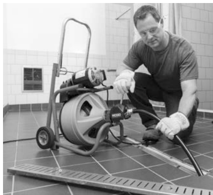
Figura 16 – Uso de la máquina con manguera-guía
