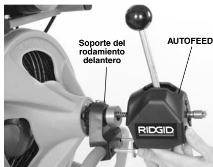
Figura 5 – Montaje del alimentador AUTOFEED sobre el armazón
