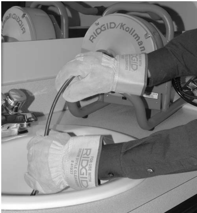
Figura 11 – Alimentación del cable en forma manual
