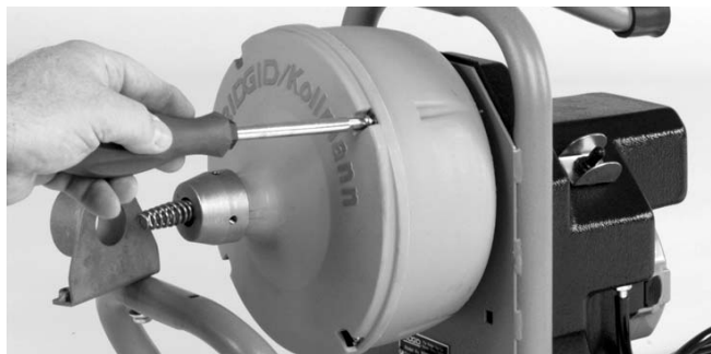
Figure 18 – Desserrer les 4 vis de tambour de 3 tours complets, mais sans les enlever.
