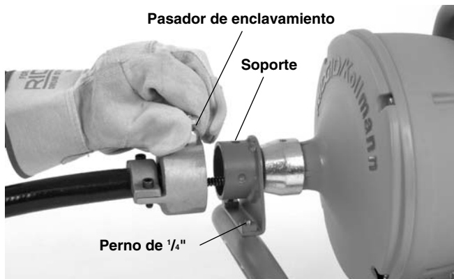
Figura 4 – Montaje de la manguera guía a la nariz de la K-40
