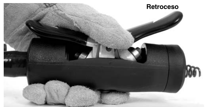
Figura 15 – AUTOFEED (foto superior) en posición de avance, (foto inferior) en posición de retroceso
