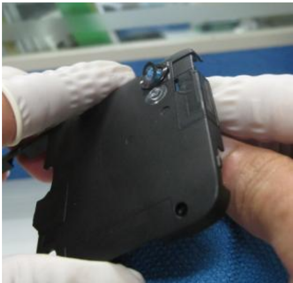
7) 用塑料镊子+无尘布慢慢顶起摄像头镜片，然后取下镜片
