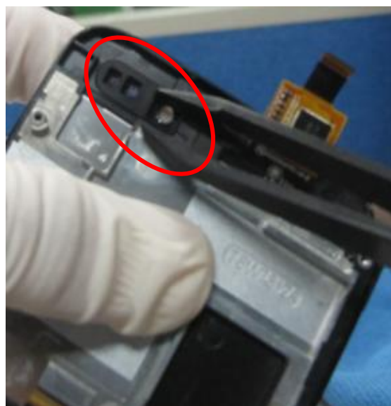
27.) 取下临近感应器避光罩, (注意装机务必装回否则打电话黑屏
