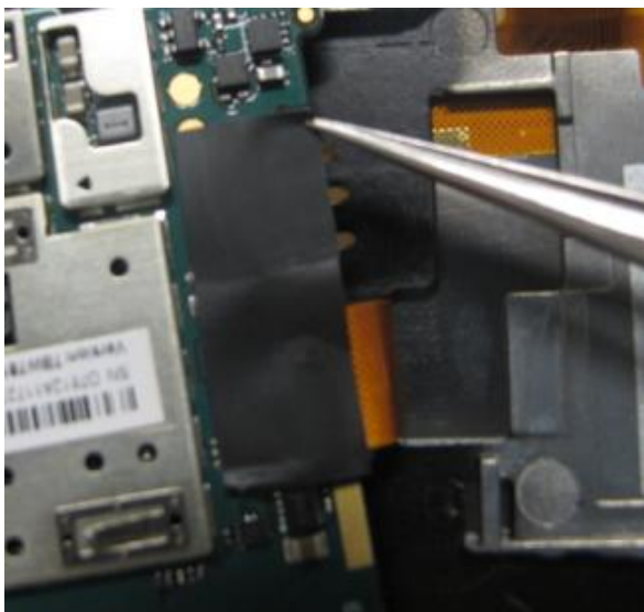
16.) 用镊子撕下主 fpc 连接器固定黑膜
