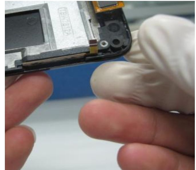
30 ) 拆下前壳音量键组件
