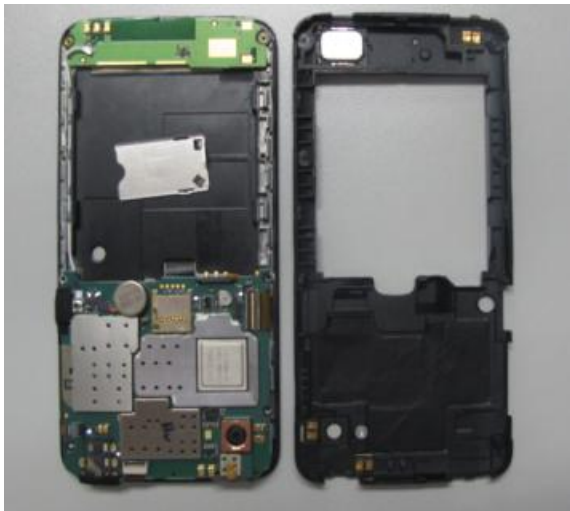
5) 拆开后壳的效果图 (妥善保管卡槽卡片装机务必装回原为 )
