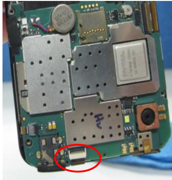
9) 打开触摸屏 FPC 接口压片
