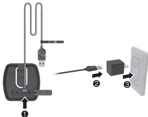
Il est recommandé de charger totalement la batterie avant la première utilisation. La charge de la batterie pour la première fois prend environ 2 à 3 heures. Le voyant du bouton d'alimentation clignote en blanc pendant la charge et s'arrête de clignoter une fois que la charge est terminée.
