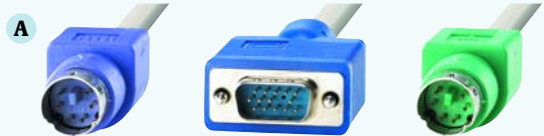
6pin Mini DIN M (PS/2 Keyboard M) HD 15pin M (VGA M) 6pin Mini DIN M (PS/2 Mouse M)
