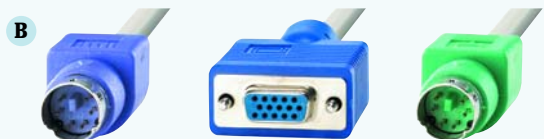
6pin Mini DIN M (PS/2 Keyboard M) HD 15pin F (VGA F) 6pin Mini DIN M (PS/2 Mouse M)
