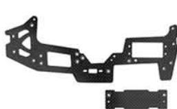
73056 PLATINE SUPERIEURE (GRAPHITE TISSE) グラファイトアッパーデッキ
