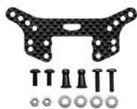
73047 SUPPORT AVANT (CARBONE TISSE) グラファイトフロントショックタワー
