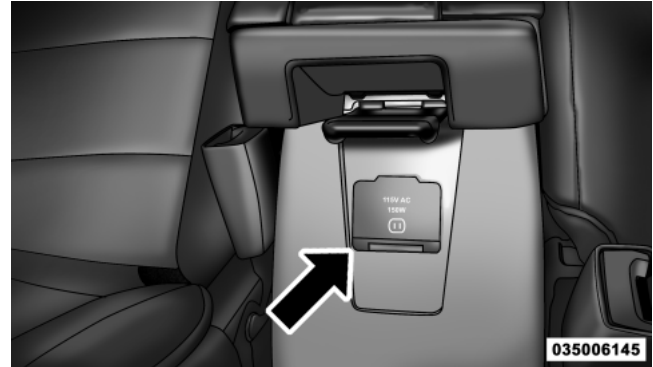
115 Volt Power Outlet
