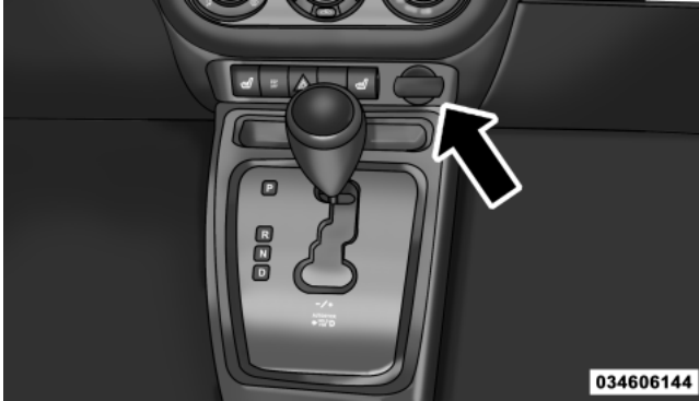
12 Volt Power Outlet
