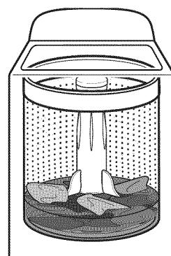
La diferencia más importante en su nueva lavadora es el sistema de lavado agipeller con bajo consumo de agua. La lavadora ajusta automáticamente el nivel de agua al tamaño de la carga; no requiere un selector de nivel de agua.
