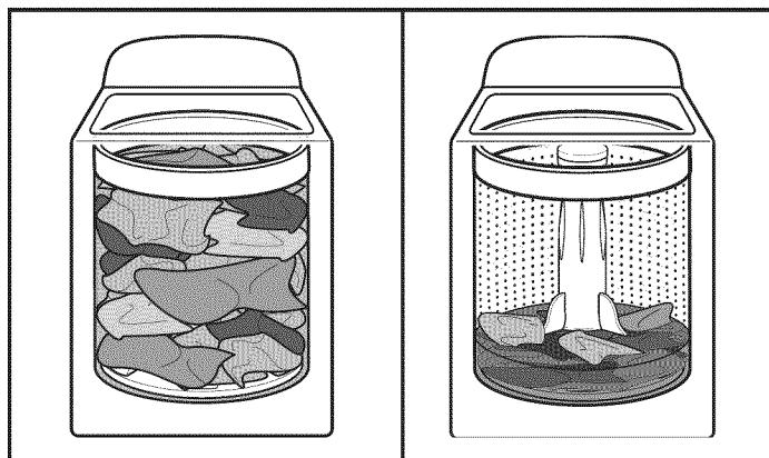
L'élément le plus caractéristique de votre nouveau lave-linge est son système à impulsor à faible consommation d'eau. Le lave-linge ajuste automatiquement le niveau d'eau à la charge ; pas besoin de sélecteur de niveau d'eau.
