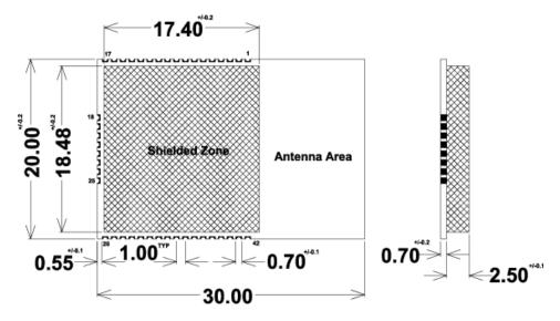
Figure 3-2. ATZB-S1-256-3-0-U Pinout
