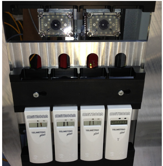
Microscan Vision HAWK Smart Kameras stellen sicher, dass die auf den Heizkostenverteiler von BRUNATA-METRONA gedruckten DataMatrix-Codes richtig und zu 100% lesbar sind.
