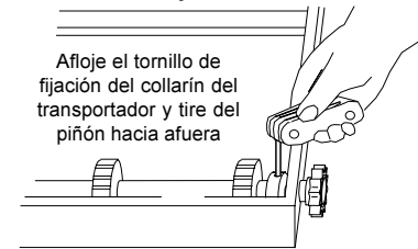
Figura 2-9 - Inserción del Transportador
