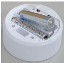
Lorsque vous installez le couvercle des piles, insérez les deux onglets d'abord, puis appuyez sur le couvercle jusqu'à ce qu'il s'enclenche.
