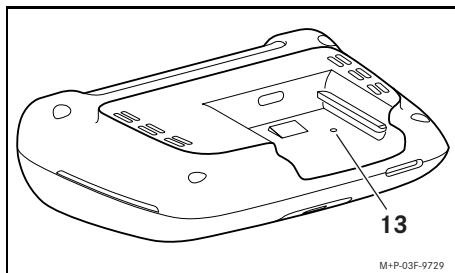
▶ 先の尖ったもので穴（13）を押します。フロントカメラは、ホルダーに再び差し込むと再始動します。
