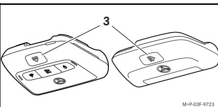
► **Verwijderen:** De knop (3) indrukken en de camera in de richting van de pijl van de houder verwijderen.
