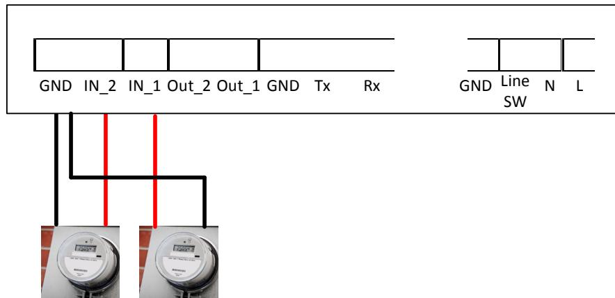
6. Mètre d'impulsions + Soupape de commande (GND,IN\_2,IN\_1,Out\_2,Out\_1)
