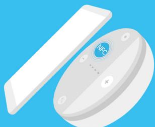
**1.** Si le téléphone portable supporte NFC (mode de lecteur), activer NFC & Bluetooth, et utiliser le téléphone pour cliquer dans la zone NFC du TicHome Mini. TicHome Mini doit être automatiquement connecté à votre téléphone.
