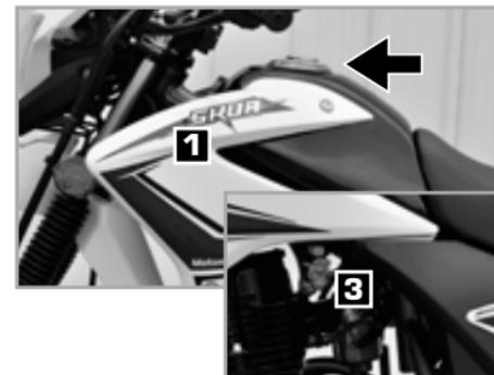
**Importante:** Para evitar derrames de combustible recuerde que la capacidad del tanque es de 12,3 litros.
