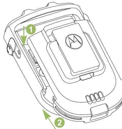
Figure 2.2: Fixation de la batterie au WRSM
