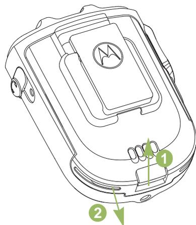
Figure 2.3: Retrait de la batterie du WRSM
