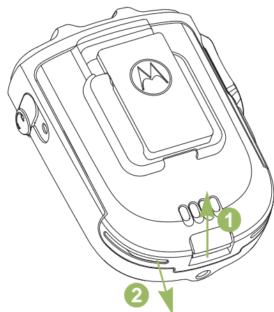
Figure 2.3: Retrait de la batterie du WRSM
