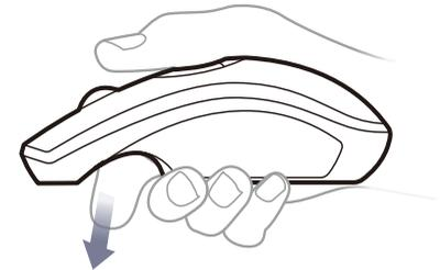
**11** Door te dubbelklikken op de In-Air-activeringstrigger plaatst u de Air Mouse in de bewegingsmodus waarin u de cursor kunt bewegen zonder de trigger ingedrukt te houden.
