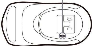
**5** Als uw product wordt geleverd met het Low Profile-toetsenbord, draait u het toetsenbord om en drukt u in de linkerbovenhoek op de verbindingsknop.
