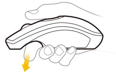
11 Appuyez deux fois sur le déclencheur d'activation dans l'espace pour activer le mode de mouvement de la souris Air Mouse et déplacer ainsi le curseur sans avoir à maintenir le déclencheur enfoncé.
