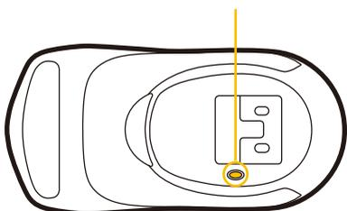
5 Si votre produit inclut un clavier ultra-plat, appuyez sur le bouton de connexion situé sous ce dernier, dans le coin supérieur gauche.
