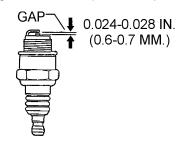
Figure 27. Spark Plug Gap
