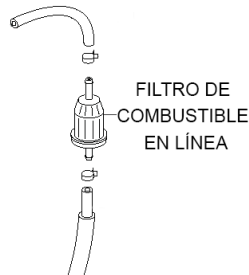
Figura 12. Filtro de combustible en línea
