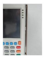
说明:磁条卡的磁条一侧边沿靠内侧,且磁条面朝向 LCD 显示屏进行刷卡操作。
