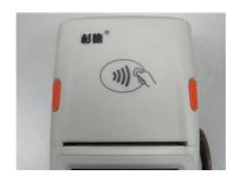
说明:带有"标识的射频卡阅读区域,被受理的卡片将被放在该区域内执行相应操作。
