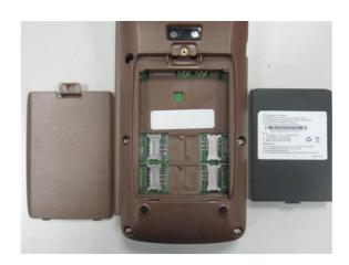
说明: 主机锂电池在未使用外接电源适配器的情况下,为主机工作提供电源,使 POS 终端移动应用成为可能。
