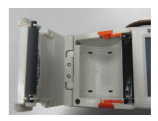
说明: 热敏打印机提供热敏纸单据打印功能,该功能区域主要由纸仓、切纸刀和热敏打印机几部分组成。
