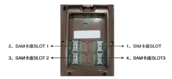
说明:通信 SIM 卡座 1 个 (位置 1,见上图),此处可插 GSM 的 SIM 卡或 CDMA 的 UIM 卡。 SAM 卡座 3 个 (位置 2/3/4,见上图),SAM 卡的定义可根据用户需要设定。
