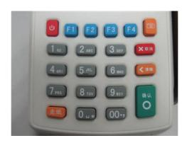
说明:包括 10 个数字键、00 快捷数字键、走纸键、取消键、清除键、确认键、电源键、摄像键以及 4 个功能键(F1~F4),总共提供了 21 个操作按键。
