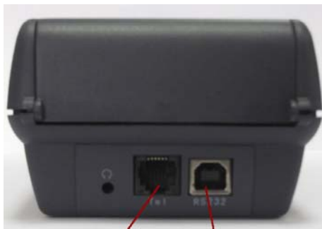
电话线 Telephone line 串口 RS232
