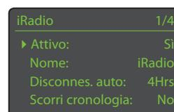
La funzione "auto off" serve per fare in modo che i limiti dell'uso dei dati del provider Internet non vengano inavvertitamente superati da un NDX/5XS lasciato collegato alla Internet Radio.
