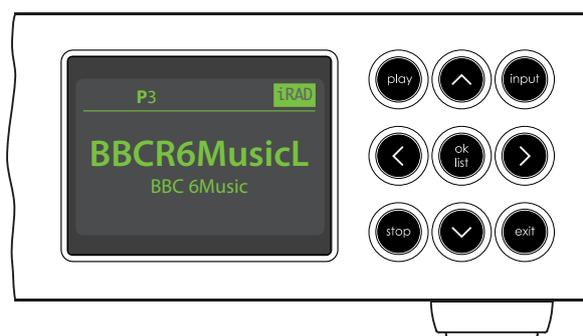
In modalità di riproduzione normale, il display di NDX/5XS fornisce una serie di informazioni sull'impostazione attuale, l'ingresso selezionato e il materiale in riproduzione. Un esempio di visualizzazione in modalità riproduzione è quello illustrato sopra, che indica la stazione Internet Radio BBC 6 Music.
