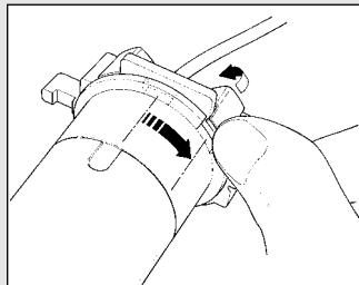
Tourner la bague jusqu'à ce que l'encoche coïncide avec l'une des dents d'accrochage, puis décrocher.
