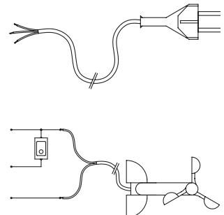
**Przy podłączeniu silnika należy zastosować wyłącznik wielobiegunowy do odłączenia od sieci elektrycznej, gdzie odległość pomiędzy stykami ma wynosić co najmniej 3 mm (wyłącznik sekcjony lub gniazdo i wtyczka, itp.)**
