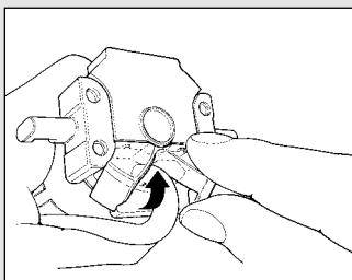
Zgasić przewód w kierunku do wnętrza i ściągnąć zabezpieczenie odkręcając delikatnie w kierunku na zewnątrz.
