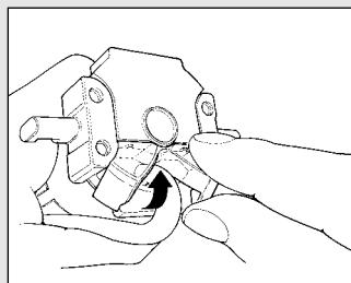
Das Kabel nach innen biegen und den Schutz entfernen, indem er behutsam nach außen gedreht wird.
