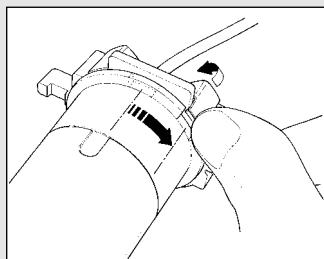
Die Nutmutter drehen, bis sich die Abkantung auf einem der Einspannzähne befindet, dann ausspannen.
