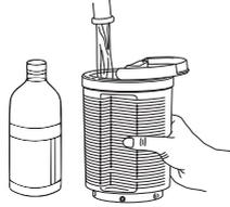
**2.** Remplissez le réservoir d'eau à la ligne de remplissage maximal avec une solution de détartrage\* et de l'eau ou du vinaigre blanc\*\* et de l'eau.
