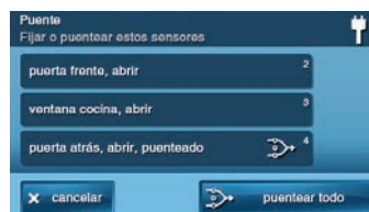
Pantalla de puenteo forzado de sensores
