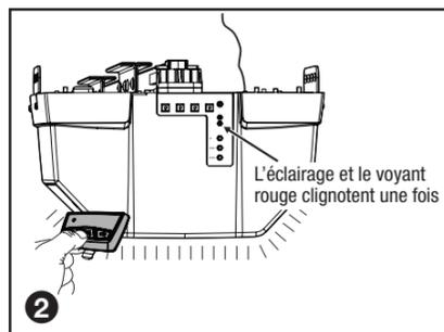
Répéter la méthode ci-dessous pour programmer d'autres boutons pour d'autres ouvre-portes de garage.
