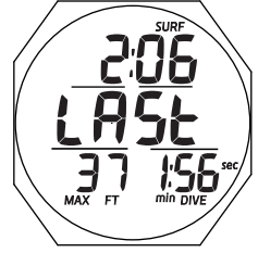
Fig. 103 - FREE SURF ALT 1 (Last Dive Data)
