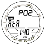
Fig. 46 - SET PO2 ALARM
