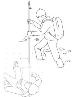
Die Sonde am Hang immer 90° zur Oberfläche einführen.
