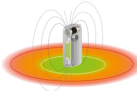
Gewöhnliches LVS-Gerät: **DRASTISCHER EINBRUCH DER REICHWEITE** bei vertikaler Senderlage. Der Verschüttete wird sehr schwer gefunden.
