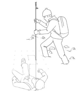
Introducir la sonda del lado inclinado siempre a 90° de la superficie.
