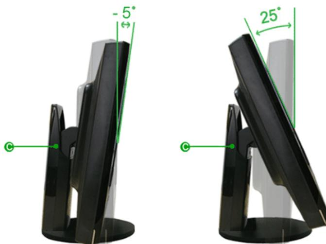
Mediante (C), puede ajustar el ángulo de inclinación con un ángulo de 5° hacia adelante hasta 25° hacia atrás para obtener un ángulo de visualización confortable.
