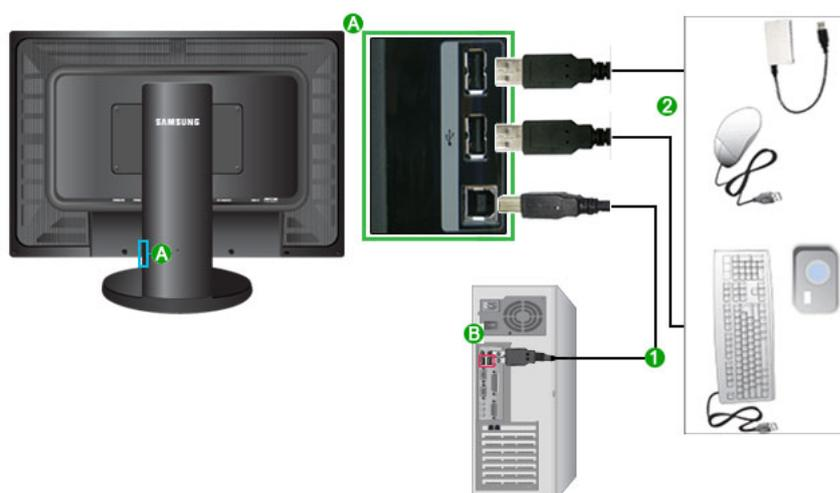
1. Conecte el puerto UP del monitor al puerto USB del ordenador mediante el cable USB.
