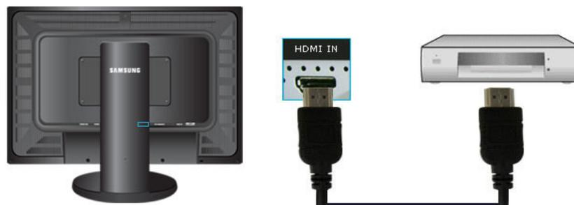
1. Los dispositivos de entrada como el DVD digital están conectados al terminal *HDMI IN* del monitor mediante el cable HDMI. Una vez realizadas todas las conexiones, conecte los cables de alimentación del monitor y del DVD (o del dispositivo conectado al terminal de salida digital).
