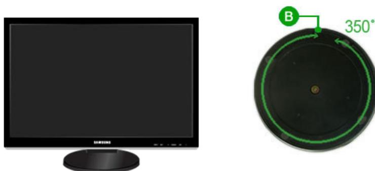
Mediante (B), puede girar el monitor a izquierda y derecha con un ángulo de 350 ° para instalar la pantalla longitudinalmente. La protección de goma bajo el soporte impide que el monitor se deslice.
