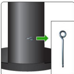
Retire el pasador de fijación del soporte antes de elevar o bajar el monitor.
