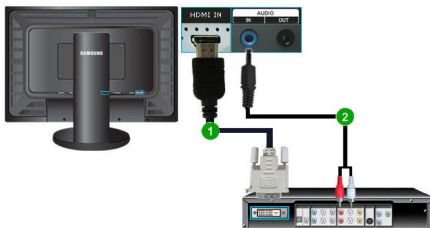
1. Conecte el terminal de salida DVI de un dispositivo con salida digital al terminal *HDMI IN* del monitor mediante el cable DVI a HDMI.
