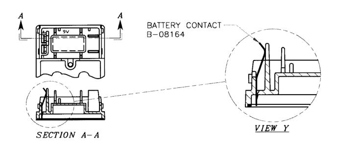
INSERT THE 2 BATTERY CONTACTS INTO THE SLOTS IN THE HOUSING AS SHOWN.
