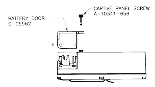
THREAD THE CAPTIVE PANEL SCREW ONTO THE BATTERY DOOR, AND SNAP THE BATTERY DOOR ONTO THE HOUSING AS SHOWN.
