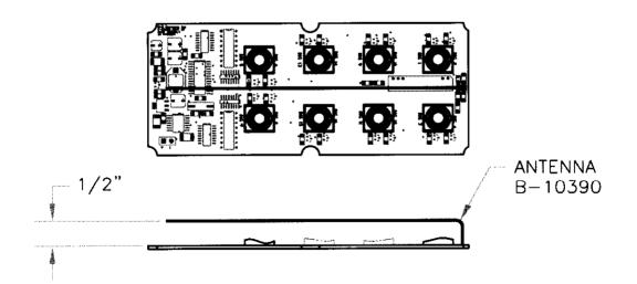
SOLDER ANTENNA ONTO BOARD AS SHOWN.
