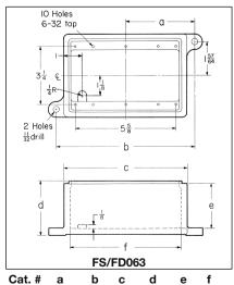
FS063 3<sup>13</sup>/<sub>16</sub> 7<sup>5</sup>/<sub>8</sub> 6<sup>7</sup>/<sub>8</sub> 2<sup>3</sup>/<sub>16</sub> 1<sup>1</sup>/<sub>2</sub> 6<sup>1</sup>/<sub>4</sub> FD063 3<sup>7</sup>/<sub>8</sub> 7<sup>1</sup>/<sub>4</sub> 7<sup>1</sup>/<sub>16</sub> 3<sup>1</sup>/<sub>32</sub> 2<sup>1</sup>/<sub>2</sub> 6<sup>3</sup>/<sub>16</sub>
