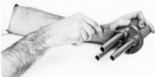
Figure 3. Extracción de la presilla de retención
