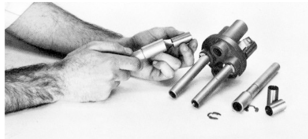
Figure 6. Installation du réducteur dans l'ouverture du contact
