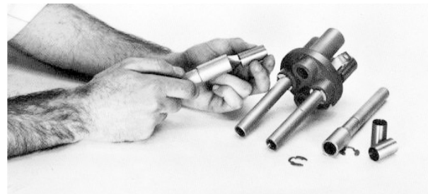
Figure 6. Instalación del reductor de cavidad de cables
