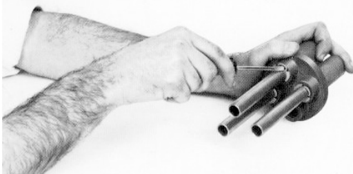
Figure 3. Enlèvement du clip de retenue
