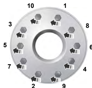
10-lug nut torque sequence
