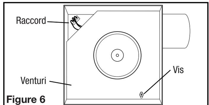
**REMARQUE :** si le raccord du moteur de ventilateur est raccordé au réceptacle du châssis, le débrancher afin que l'assemblage de la soufflante soit complètement enlevé.
