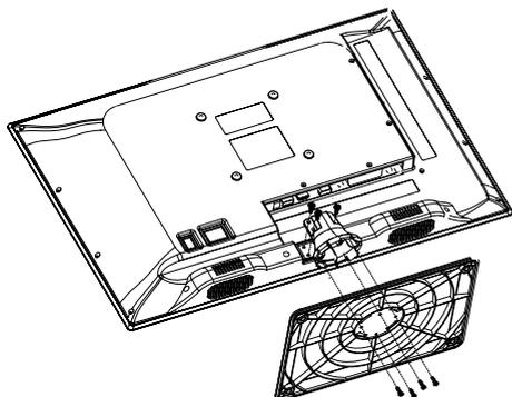
Выберите ровную плоскую горизонтальную поверхность, накройте ее мягкой тканью и разместите на ней корпус телевизора экраном вниз. Присоедините подставку к основанию таким образом, чтобы отверстия в подставке и в основании совпадали. Зафиксируйте подставку с помощью 3 винтов. Присоедините подставку вместе с основанием к задней части корпуса телевизора таким образом, чтобы отверстия в подставке и в корпусе совпали. Зафиксируйте подставку с помощью 4 винтов.
