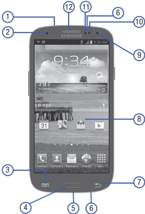
5. **Conector USB para alimentación/accesorios:** le permite conectar un cable de alimentación o accesorios opcionales como un cable USB/de datos.
