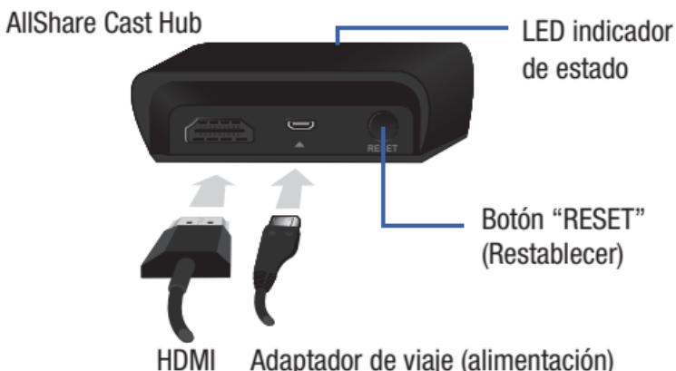
1. Conecte el concentrador de AllShare Cast a una fuente de energía mediante el adaptador de viaje USB.
