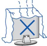
Устанавливайте телевизор в соответствии с инструкциями изготовителя. Не закрывайте вентиляционные и другие отверстия, так как недостаточная вентиляция может вызвать перегрев и сокращение срока службы телевизора.
