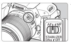
On the lens, set the focus mode switch to <AF>.
