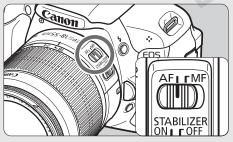
Set the lens focus mode switch to <AF>. (p.36)
