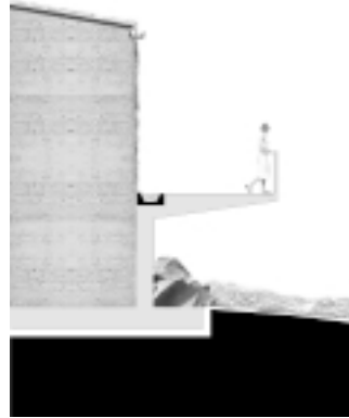
Las aguas lluvias se evacúan a través del corredor urbano en voladizo.
