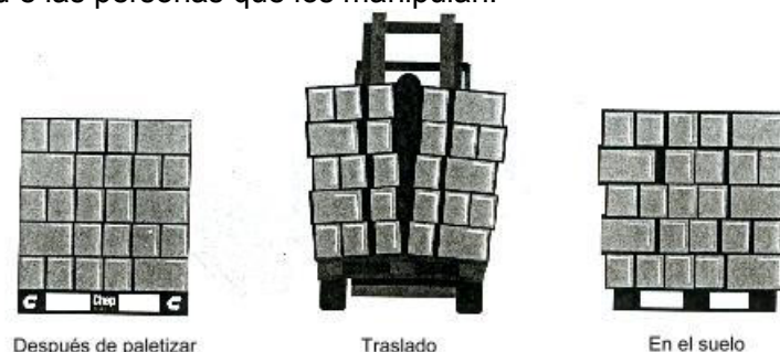
Imagen 26. Transporte de estiba no paletizada
