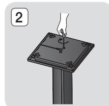
3. Endireite um fio do alto-falante fornecido e coloque-o no orifício no centro da Base do pedestal.
