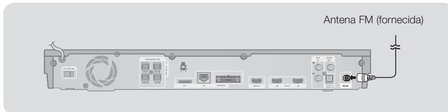
1. Acople a antena FM fornecida ao conector de ANTENA FM.
