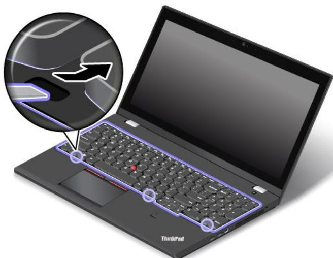
7. Ослабьте винты, которыми закреплена клавиатура, с помощью крестового конца многофункционального инструмента для клавиатуры.
