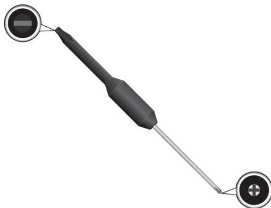
6. Для получения доступа к головкам винтов, расположенных под рамкой клавиатуры, сдвиньте рамку клавиатуры вперед на 2,5 мм с помощью плоского торцевого конца многофункционального инструмента для клавиатуры.
