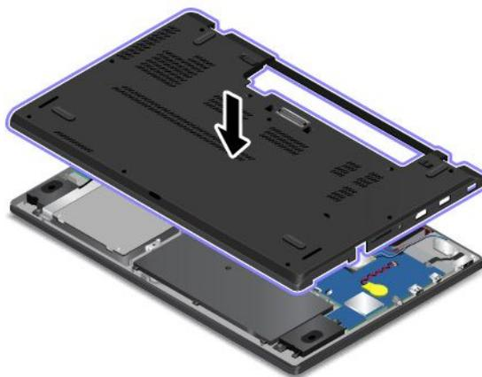
7. Затяните винты, фиксирующие узел крышки корпуса.
