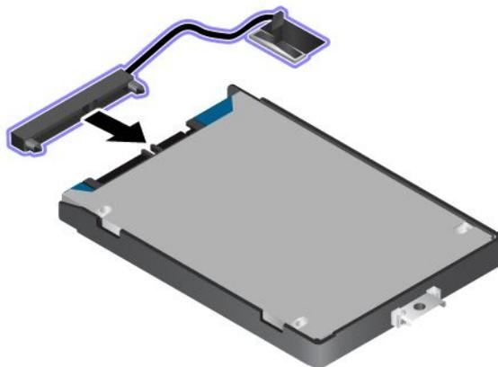
9. Прежде всего, проложите кабель диска через стабилизатор устройства хранения. Затем установите диск на место.
