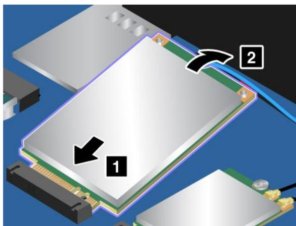
9. Установите винт и зафиксируйте карту беспроводной глобальной сети.
