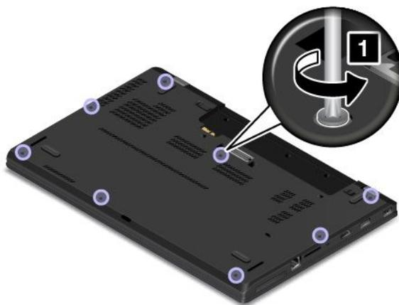
5. Отожмите защелки, затем извлеките узел крышки корпуса.
