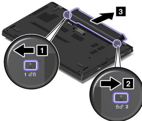
3. Вставьте новый аккумулятор на место до щелчка. Убедитесь, что защелки отсека аккумулятора находятся в закрытом положении.
