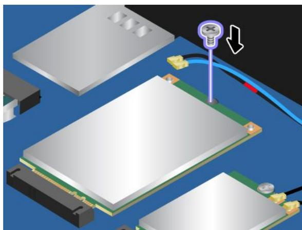
10. Подсоедините антенные кабели к карте беспроводной глобальной сети. Кабель с красной меткой должен быть подключен к главному разъему, а синий кабель — к вспомогательному разъему на карте беспроводной глобальной сети.
