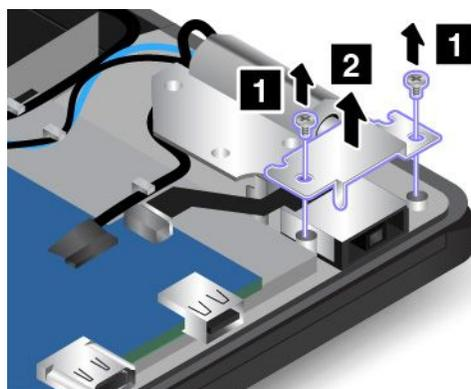
6. Отсоедините кабель с входным разъемом постоянного тока от материнской платы и затем извлеките узел кабеля.
