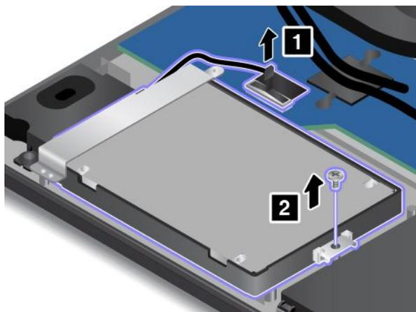
6. Поднимите диск за язычок и немного вытяните из отсека **1**. Осторожно вытяните кабель диска через стабилизатор устройства хранения **2** и затем извлеките диск.
