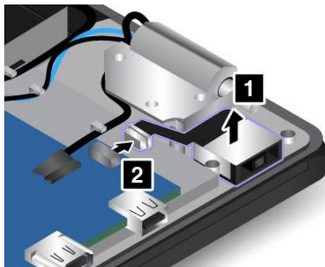
7. Установите новый кабель с входным разъемом постоянного тока на место и подключите его к материнской плате.
