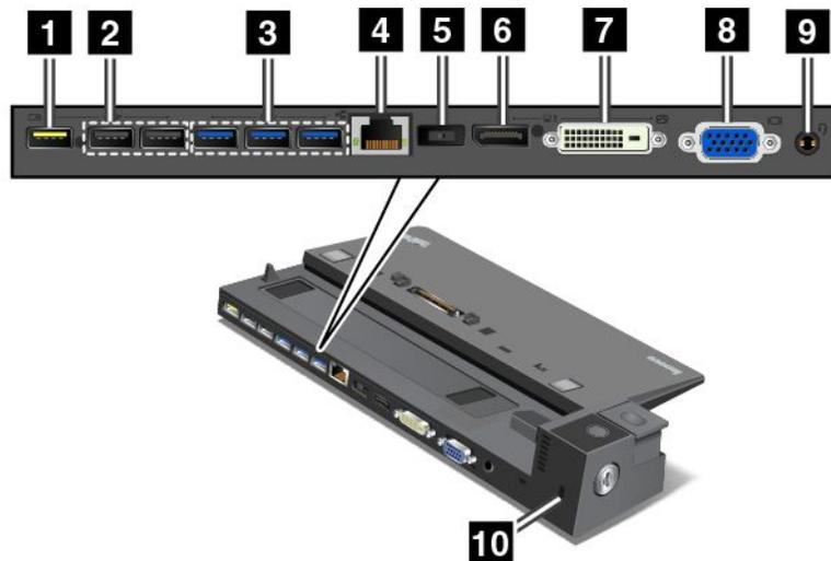
**1 Разъем “Всегда включенный USB”:** используется для подключения устройств, совместимых с USB, или зарядки некоторых мобильных цифровых устройств и смартфонов, когда компьютер находится в спящем режиме или режиме гибернации.
