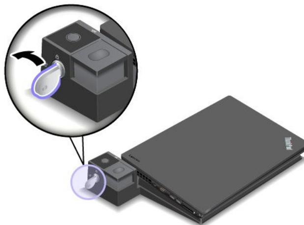
3. Нажимайте кнопку извлечения, пока компьютер не сдвинется вверх. Затем возьмитесь за обе стороны компьютера и отсоедините его.
