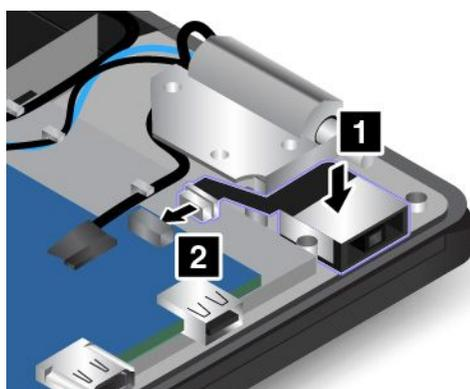
**Внимание:** Не прокладываете кабель с входным разъемом постоянного тока поверх навески. Иначе кабель с входным разъемом постоянного тока может получить повреждения при установке узла крышки корпуса.
