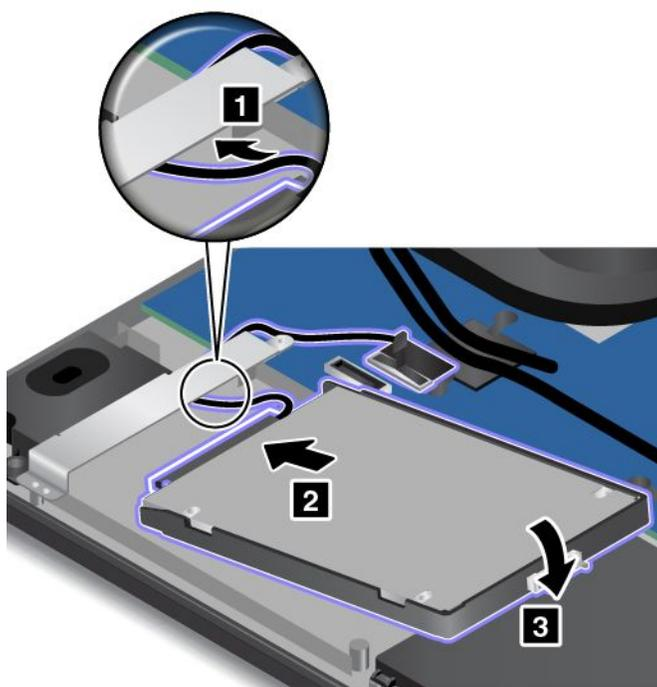
10. Установите на место винт для крепления устройства хранения и подключите кабель диска к материнской плате.
