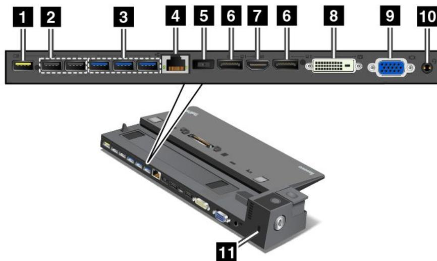
**1 Разъем “Всегда включенный USB”:** используется для подключения устройств, совместимых с USB, или зарядки некоторых мобильных цифровых устройств и смартфонов, когда компьютер находится в спящем режиме или режиме гибернации.
