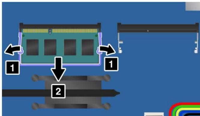
6. Вставьте модуль памяти в гнездо модуля памяти под углом примерно 20 градусов **1**. Поверните модуль памяти вниз так, чтобы он встал на место **2**. Убедитесь в том, что модуль памяти надежно зафиксирован и не качается в гнезде модуля памяти.
