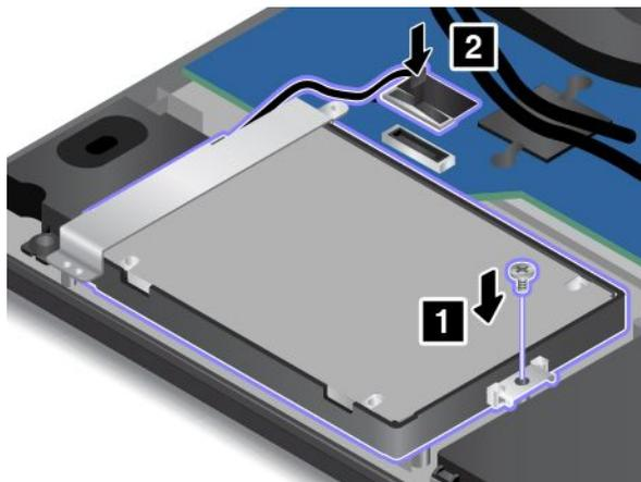
**Внимание:** Не укладывайте кабель на стабилизаторе устройства хранения. Иначе кабель может получить повреждения при установке узла крышки корпуса.
