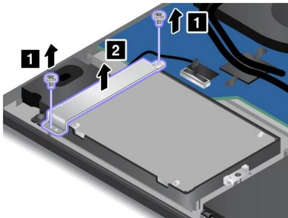
6. Установите винты и новый стабилизатор устройства хранения на место.
