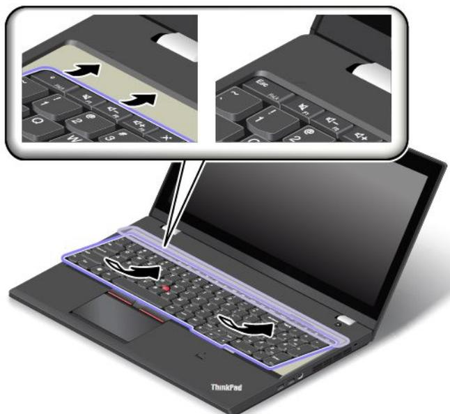
3. Освободите доступ к головкам винтов, сдвинув рамку клавиатуры вперед с помощью плоского торцевого конца многофункционального инструмента для клавиатуры. Убедитесь, что головки винтов полностью доступны.
