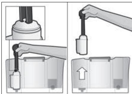
**i** Przepłukanie filtra spowodowało aktywację ustawienia wskaźnika „Proszę wymienić filtr wody”.
